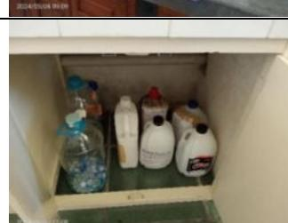
El LABORATORIO DE CONVERSIÓN DE ENERGÍA debe poseer un cubeto de contención contra derrames con piso y paredes impermeabilizadas, para el almacenamiento de los desechos peligrosos líquidos. Este cubeto podrá ser un contenedor de plástico rígido con similares medidas como el de la imagen referencial.
